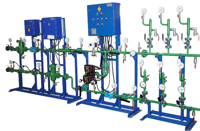
Взлет АТП автоматизированный тепловой пункт
